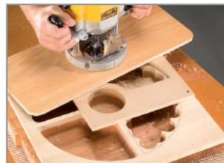
Formen Sie die Innenseite des Tabletts mit dem Fräser und dem Spannfutter aus.
