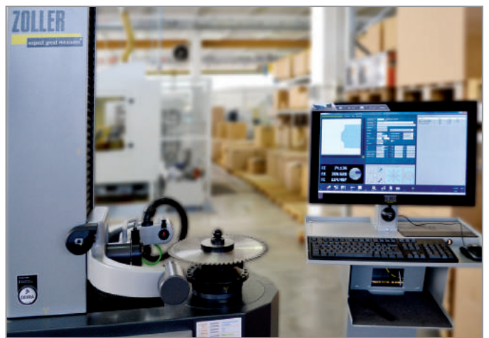
Das vollständig automatisierte CMT-Kontrollsystem.
