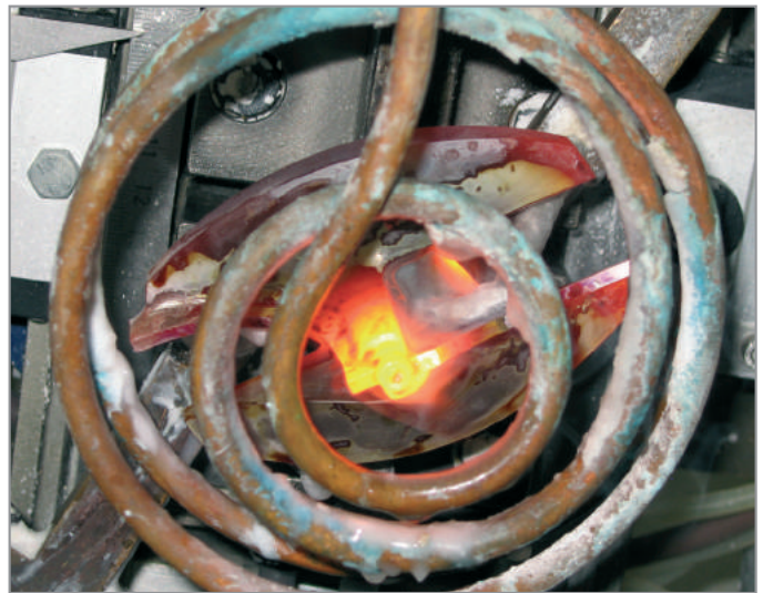
Löten bei 680° in wenigen Sekunden.
