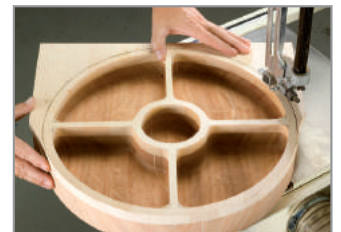
Benutzen Sie einen Bandschleifer, um die Außenseite des Tabletts zu schleifen.
