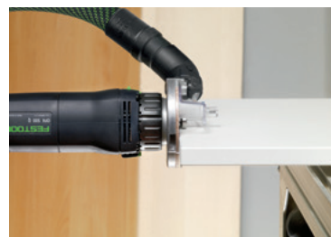
Redondeado para cantos de encolado en plástico y madera maciza.
