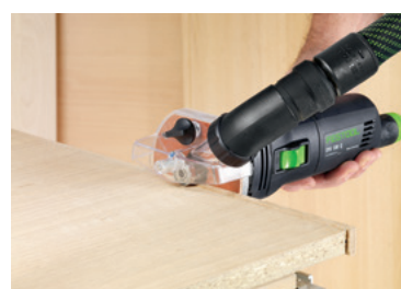
Para enrasar perfiles de encolar para rebordes de plástico o madera maciza.
