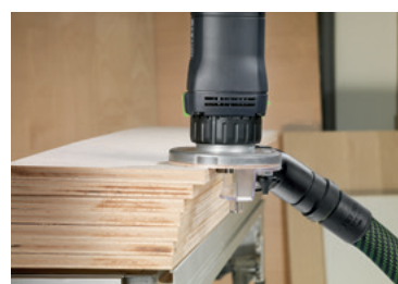
Fresado a bisel para cantos de encolado en plástico y madera maciza.
