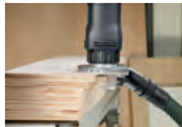
Chanfreiner les couvre-chants en plastique ou en bois massif
