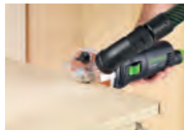
Araser les couvre-chants en plastique ou en bois massif
